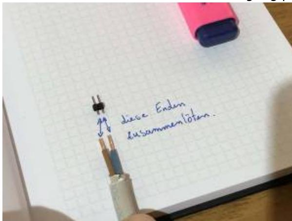
3. An einer weiteren Stelle, die bestmöglich Bezug auf den Inhalt des Plakates nimmt, wird nun ebenfalls die Plastik-Isolierung entfernt und zwei metallische Drähte freigelegt. Diese sollten die selbe Farbe haben, wie die Drähte, die am Anfang bearbeitet wurden. Überlegen Sie also an welcher Stelle des Plakates es Sinn macht eine rot-blinke LED zu integrieren. Im unteren Beispiel 1 wäre es etwa das rechte Kabelende, in Beispiel 2 womöglich irgendwo in der Mitte des Kabels.
