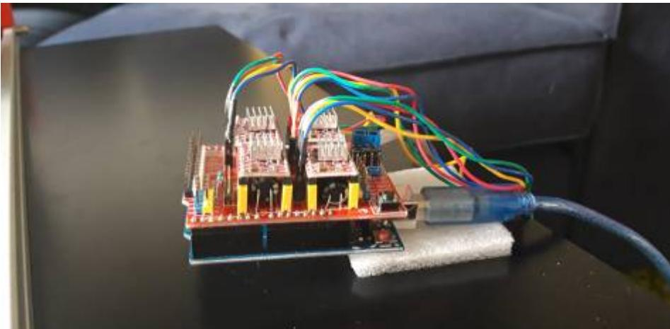
Sind die Kabel alle mit den Steckern verlötet müssen diese nun ins Board gesteckt werden. Auf der Platine finden sich die Bezeichnung X,Y,Z und A, welche für die X-, Y- und Z-Achsen der CNC Maschine stehen (A dubliert die Y-Achse). Dementsprechend sollten die Stecker der Motorenachsen jeweils passend zur Bezeichnung der Achsen auf dem Board verbunden werden.
