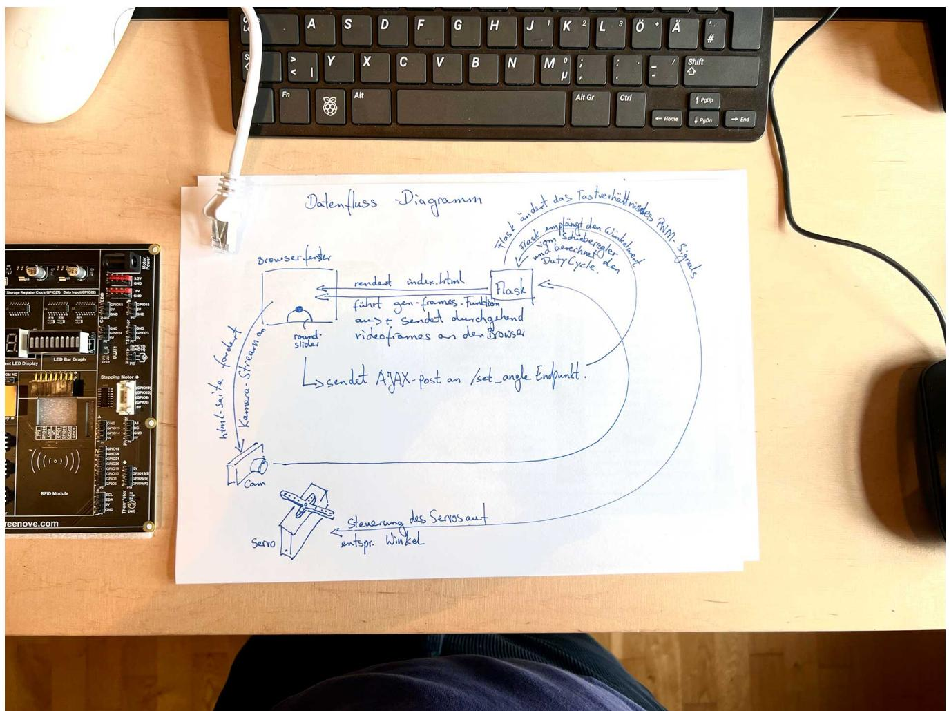
Obiges Datenfluss-Diagramm gibt einen Überblick, wie die verschiedenen Teile der Anwendung zusammenarbeiten, um die Steuerung des Servomotors über den runden Schieberegler in der Webanwendung zu ermöglichen.
